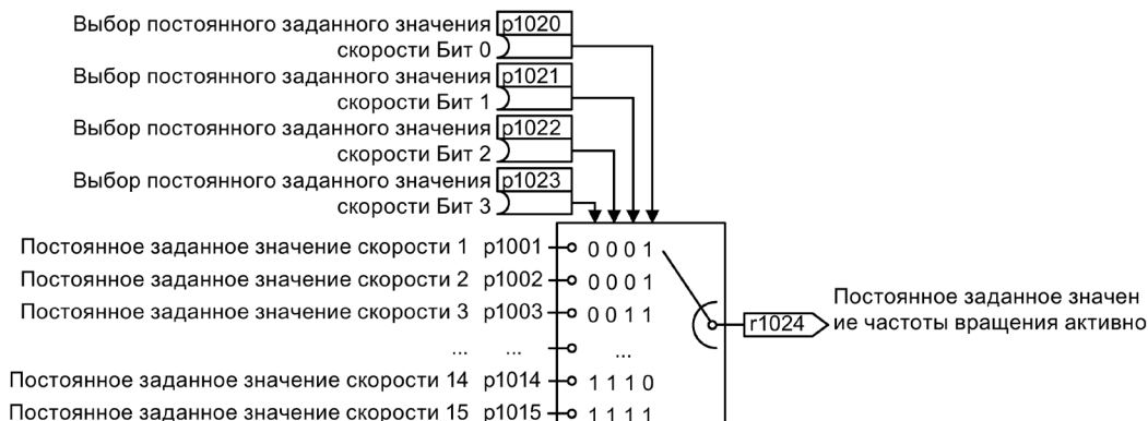
Рисунок 7-30 Упрощенная функциональная схема при двоичном выборе постоянных заданных значений
