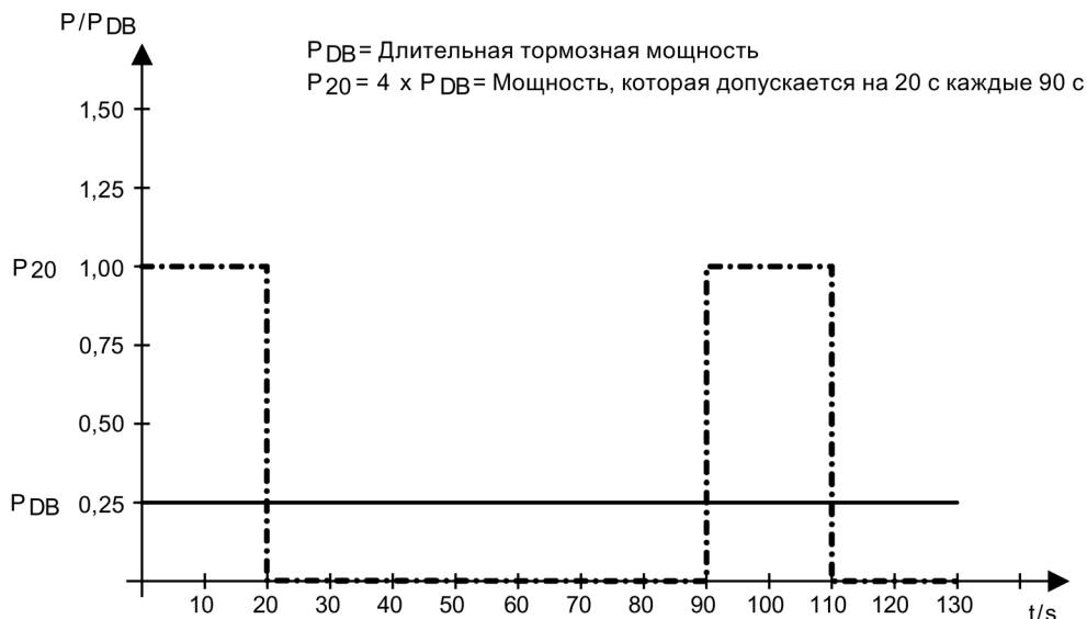
Рисунок 4-22 Нагрузочные циклы тормозных сопротивлений
